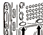
Appuyez sur la touche de sélection de bande (L ou R). Lorsque vous effectuez cette manipulation dans un autre mode que le mode VFO l'appareil sélectionne le mode VFO. Lorsque vous effectuez cette manipulation en mode VFO l'appareil passe d'un VFO à l'autre.
